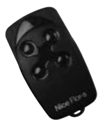
FLO/FLO dálkové ovládání s plovoucím kódem, 433.92 MHz
